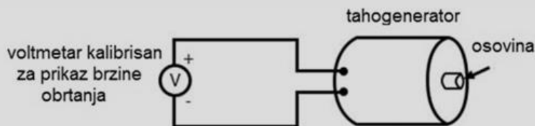
Slika 1 – Merenje brzine obrtanja tahogeneratorom
